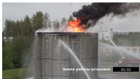
Ход испытаний по тушению РВС-2000 компрессионной пеной, генерируемой оборудованием Smart Foam ООО «СТАЛТ»
