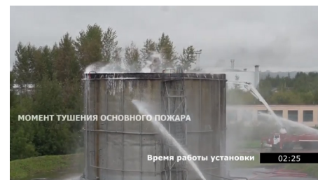
Ход испытаний по тушению РВС-2000 компрессионной пеной, генерируемой оборудованием Smart Foam ООО «СТАЛТ»
