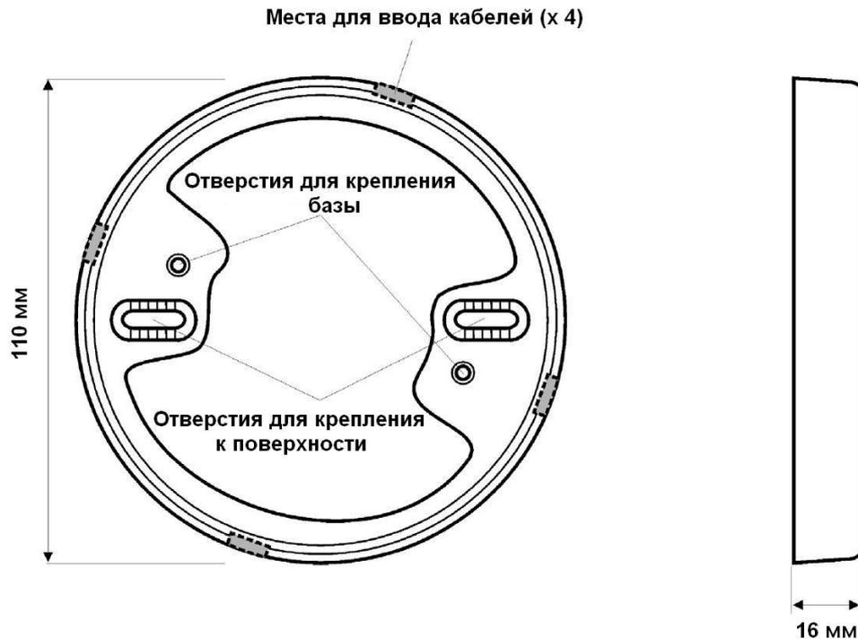
Адаптер имеет четыре специально подготовленных места на корпусе размером 9 мм x 8 мм (см. рисунки 1 и 2), позволяющих подключать провода открытой проводки к монтажной базе извещателя. Адаптер существует в двух цветовых вариантах – светло-бежевом и белом, совпадающих со стандартными цветами извещателей Ночики.
