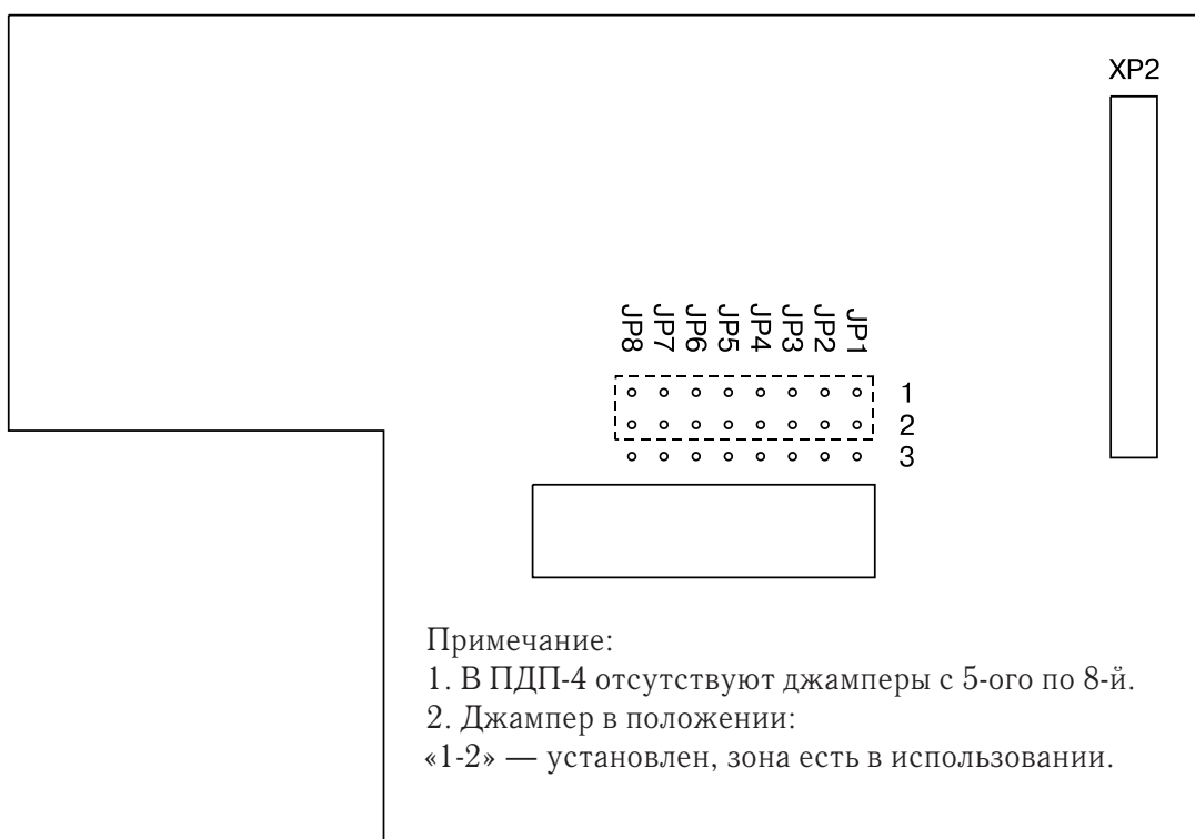
Схема расположения установки джамперов для платы контроллера ПДП-4 и ПДП-8 Установка джамперов на ПДП-8 и ППКиУП АСТ-4
